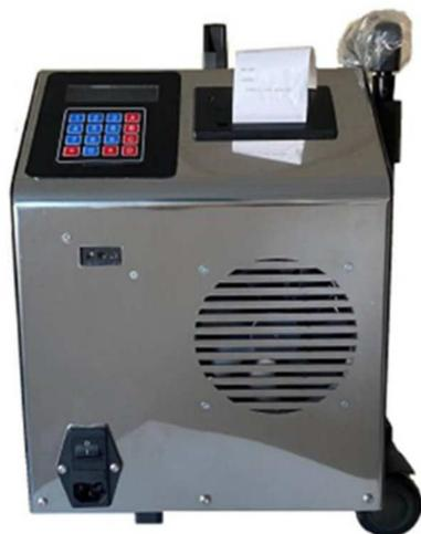
Il macchinario "AlSicuro" è un sistema brevettato con una procedura certificata secondo le normative vigenti che, mediante l'atomizzazione, raggiunge tutte le superfici e gli oggetti presenti, anche quelli a cui non è possibile arrivare con l'intervento manuale. La macchina emette un certificato di avvenuto trattamento, rilasciando uno scontrino con garanzie indelebili in caso di incidenti derivanti dal questioni relative al COVID.
